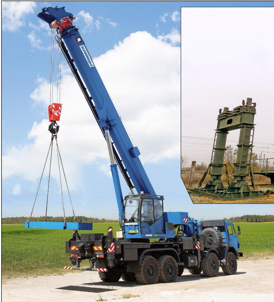
Движение с грузом 3т на вылете 4м Штоки гидроцилиндров опор подняты
