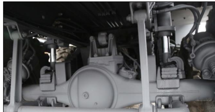
Механизм блокировки задней балансирной подвески
