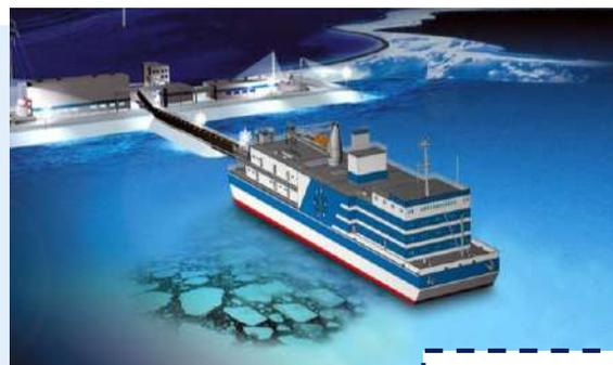
Плавающий энергоблок (ПЭБ-180) в арктическом исполнении
