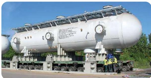
Крупногабаритные реакторы, колонны, ёмкости и др. сосуды под давлением единичной массой 60-1 000 тн
