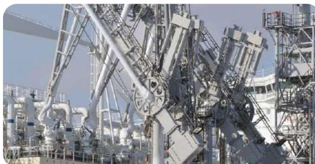
Стендеры отгрузки СПГ в наземном и морском исполнении для перекачки криогенных сред
