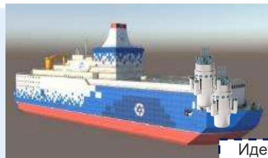
Модернизированный плавающий энергоблок (ПЭБ-106) в арктическом исполнении
