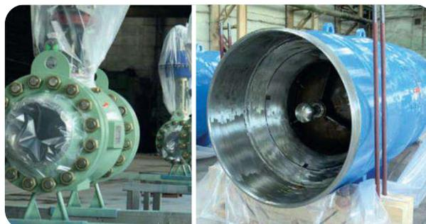
Обратные и осесимметричные клапаны Ø250-1400 мм для магистральных нефте- и газопроводов
